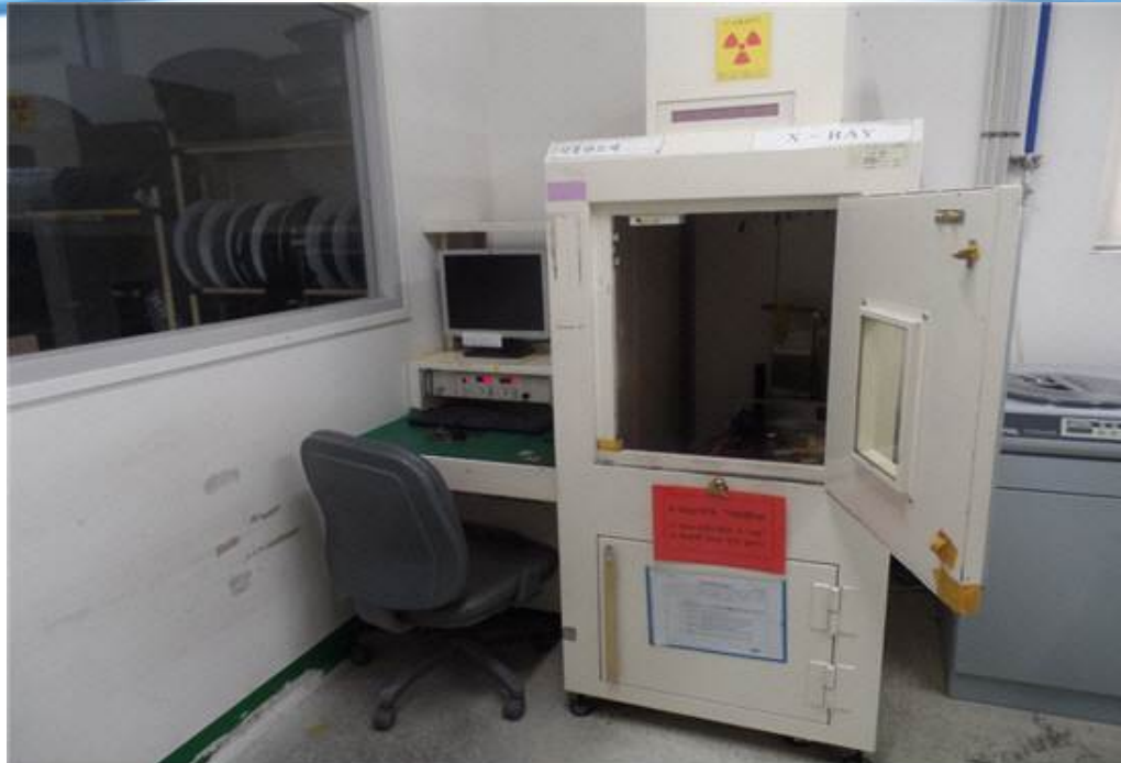
X레이 발생장치 SOFTEX SFX-100 <사진:원자력안전위원회>
